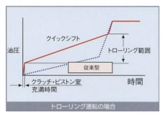
通常運転時は初期段階から高い油圧を供給しますのでピストン室が短時間で充満し、ピストンが早く動き出します。また、トローリング運転時は従来型より高圧で制御しますので安定した制御性が得られます。
